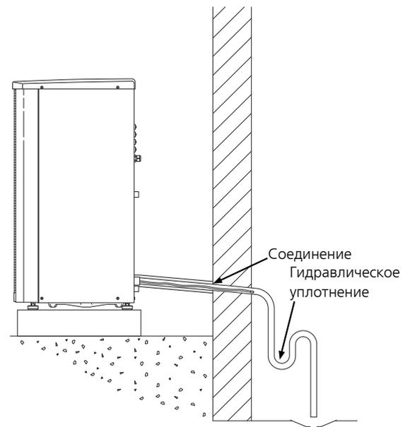
Водный конденсат отводится в дренажную систему внутри помещения (с соблюдением местных нормативных требований и постановлений).
