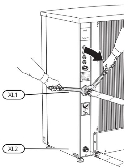
XL1 Соединение, подача теплоносителя из F2120
