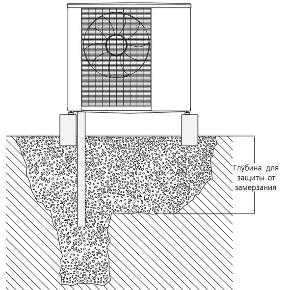
При наличии в здании подвала каменный кессон должен устанавливаться так, чтобы водный конденсат не повредил здание. В противном случае каменный кессон следует устанавливать непосредственно под тепловым насосом.
