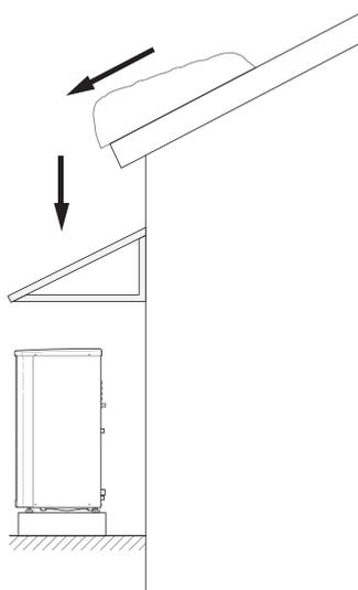
Если имеется риск соскальзывания снега с крыши, необходимо установить защитную крышку или козырек для защиты теплового насоса, труб и проводки.
