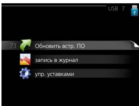
С помощью меню 7.1 внутреннего модуля / модуля управления можно обновить следующее программное обеспечение:
