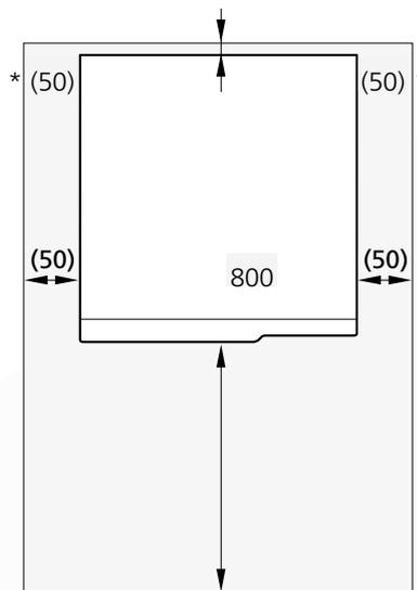
\* Требуемое расстояние при обычной установке составляет 300—400 мм (со всех сторон) для подключения оборудования - уравнивательного сосуда, клапанов и электрооборудования.
